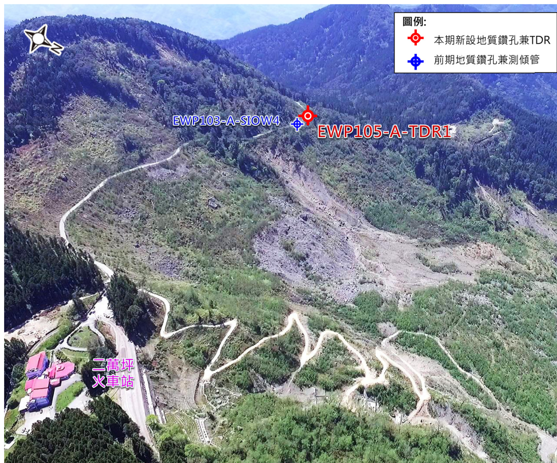
圖 3.45 二萬坪補充地質調查鑽孔配置位置
