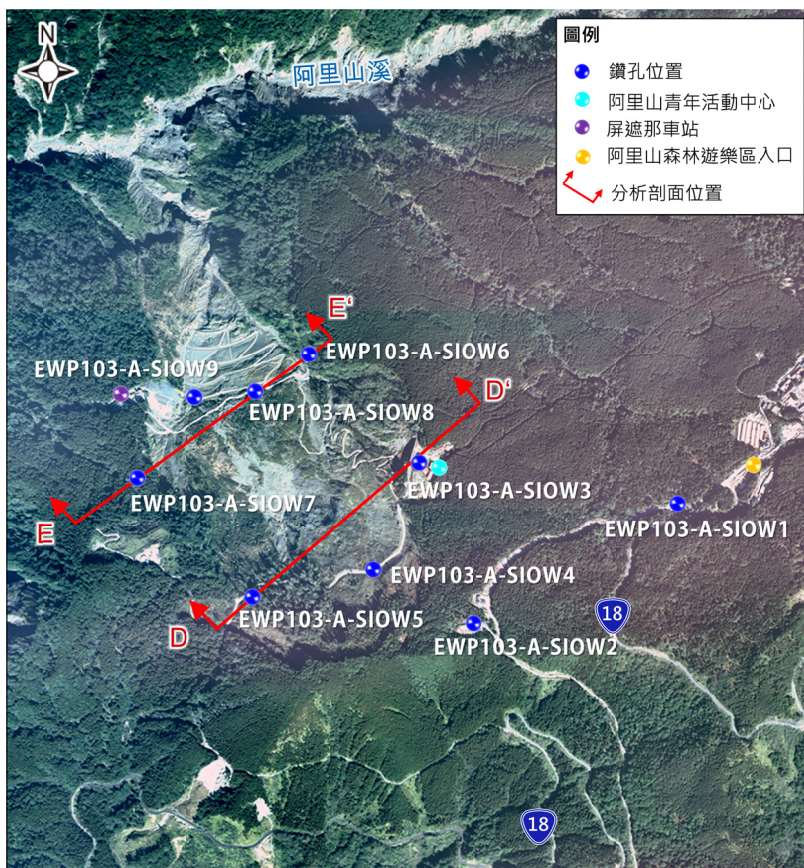
(b) 平行坡面剖面 DD' 及 EE'
